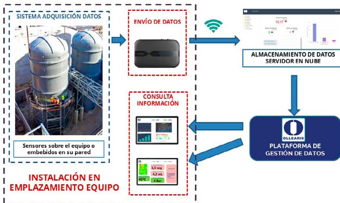
Figura 2 – Esquema de la arquitectura de un sistema de sensorización y tratamiento de datos con sensores instalados o embebidos en un equipo de PRFV.
