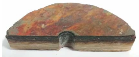
Figura 1 – Muestra extraída de un tanque de almacenamiento de ácido sulfúrico. Puede observarse el cambio de coloración en parte de su espesor debido a la difusión del ácido sulfúrico a través de la pared, pero sin pérdida de espesor de ésta.
